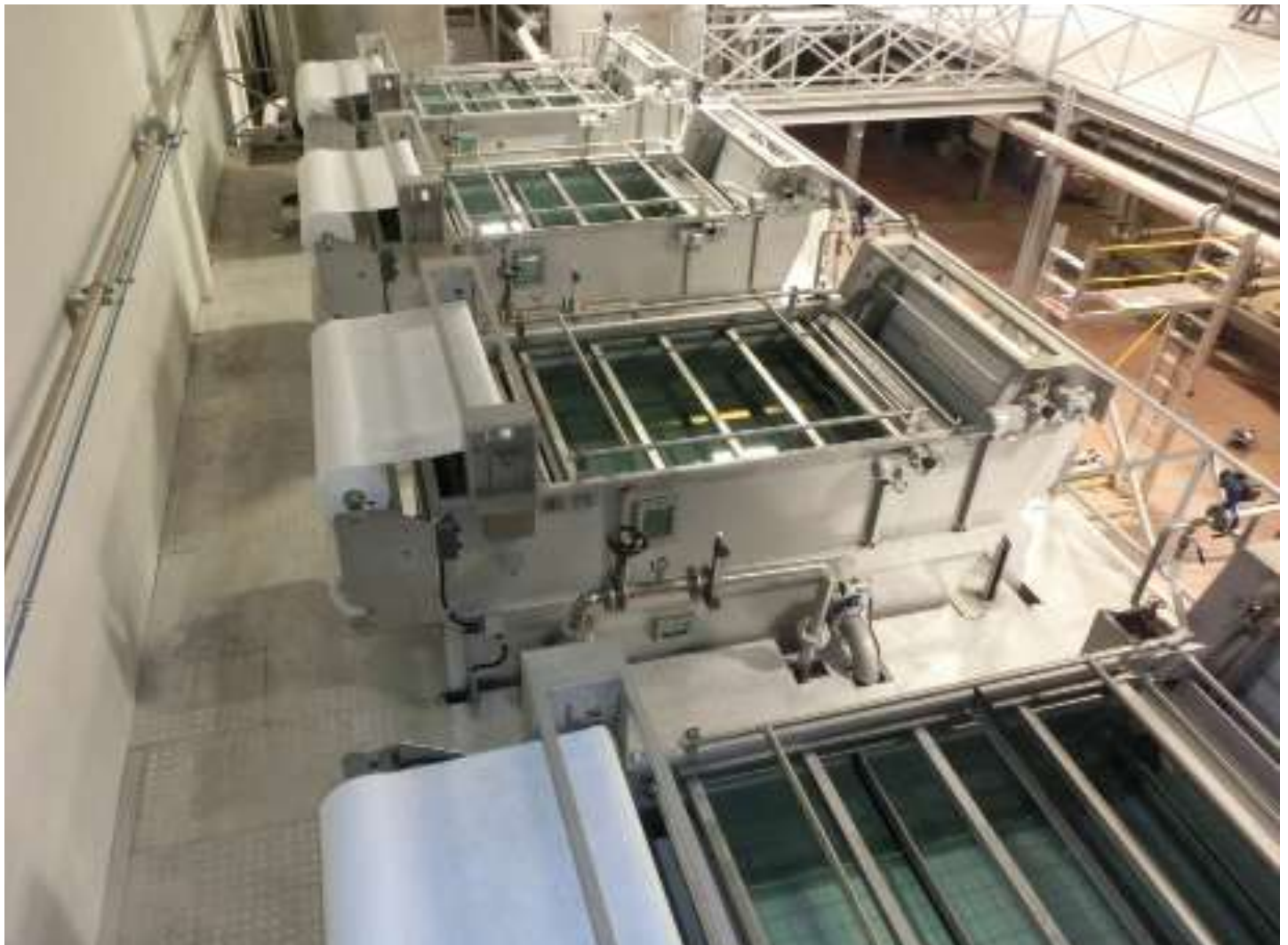
SISTEMA COMPUESTO POR SERIE DE 4 BAND FLOAT (BAF) EN FÁBRICA DE SPUNLACE
