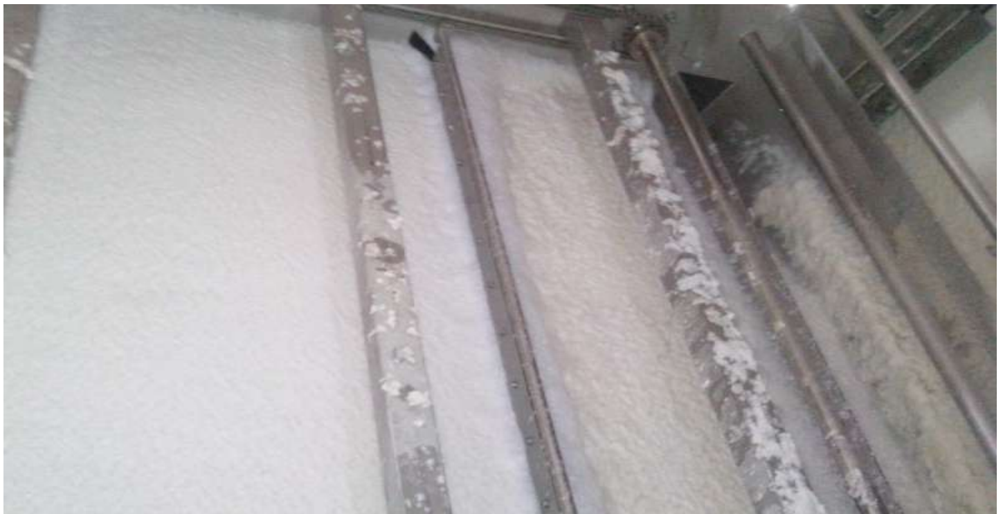
VISTA DE LA SEPARACIÓN DE LA PULPA A TRAVÉS DE LA VENTANA DE INSPECCIÓN DEL BAND FLOAT (BAF)SIDERÚRGICA
