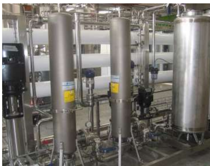
SISTEMA PARA RECUPERACIÓN DE SUERO ENSAMBLADO EN MÓDULO ÚNICO DE ACERO INOXIDABLE Y CON FUNCIONAMIENTO COMPLETAMENTE AUTOMÁTICO.
