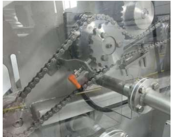
MECANISMO AUTOMÁTICO QUE CONTROLA EL MOVIMIENTO DE LA BANDA DEL BAND FLOAT: EL SENSOR DE MOVIMIENTO DE LA BANDA (PARTE COLOR NARANJA) SE ENCARGA DE ENVIAR UNA SEÑAL AL PLC EN CASO DE OBSTRUCCIÓN DE LA BANDA.
