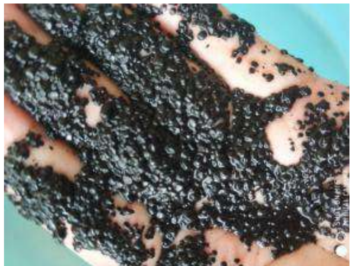
CONSISTENCIA Y DIMENSIONES DEL LODO GRANULAR PRODUCIDO POR EL REACTOR UASB
