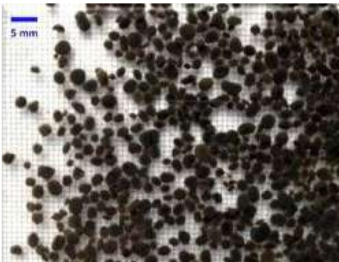
CONSISTENCIA Y DIMENSIONES DEL LODO GRANULAR PRODUCIDO POR EL REACTOR UASB
