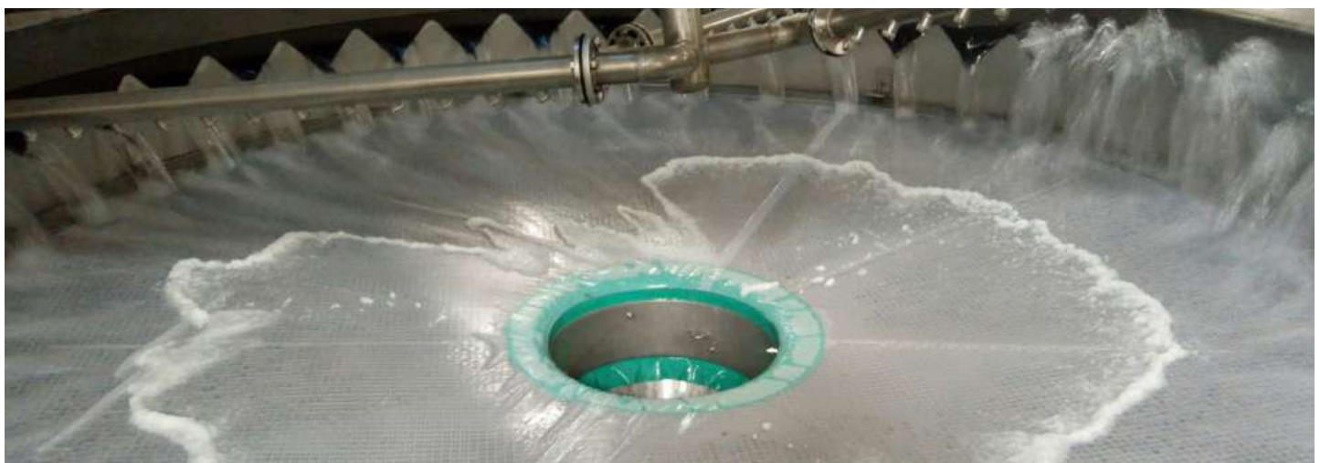
FLUJO DEL AGUA HACIA LA PARTE CENTRAL DEL GRAVITY STRAINER
